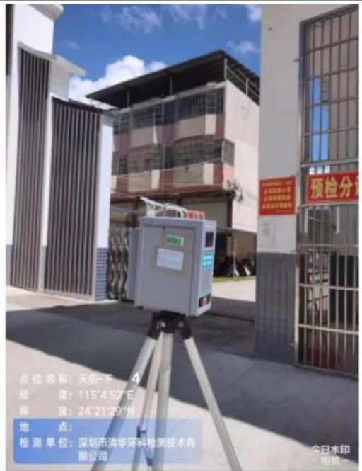
无组织废气下风向检测点 4#
