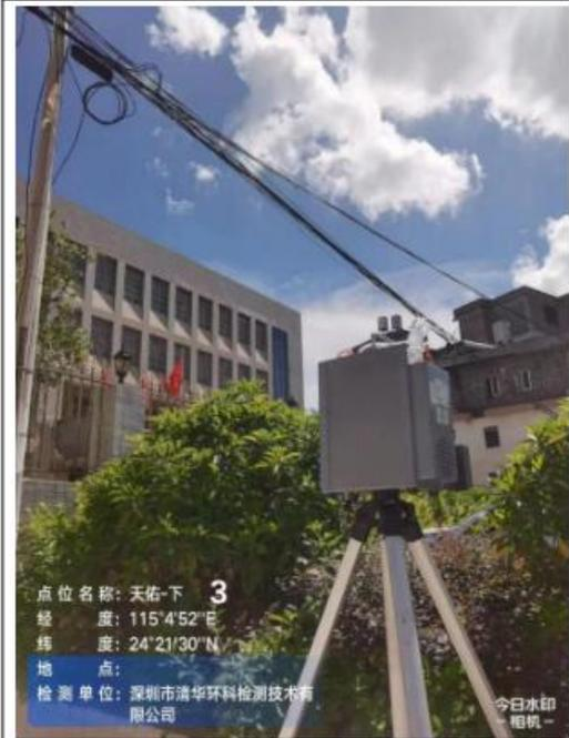
无组织废气下风向检测点 3#
